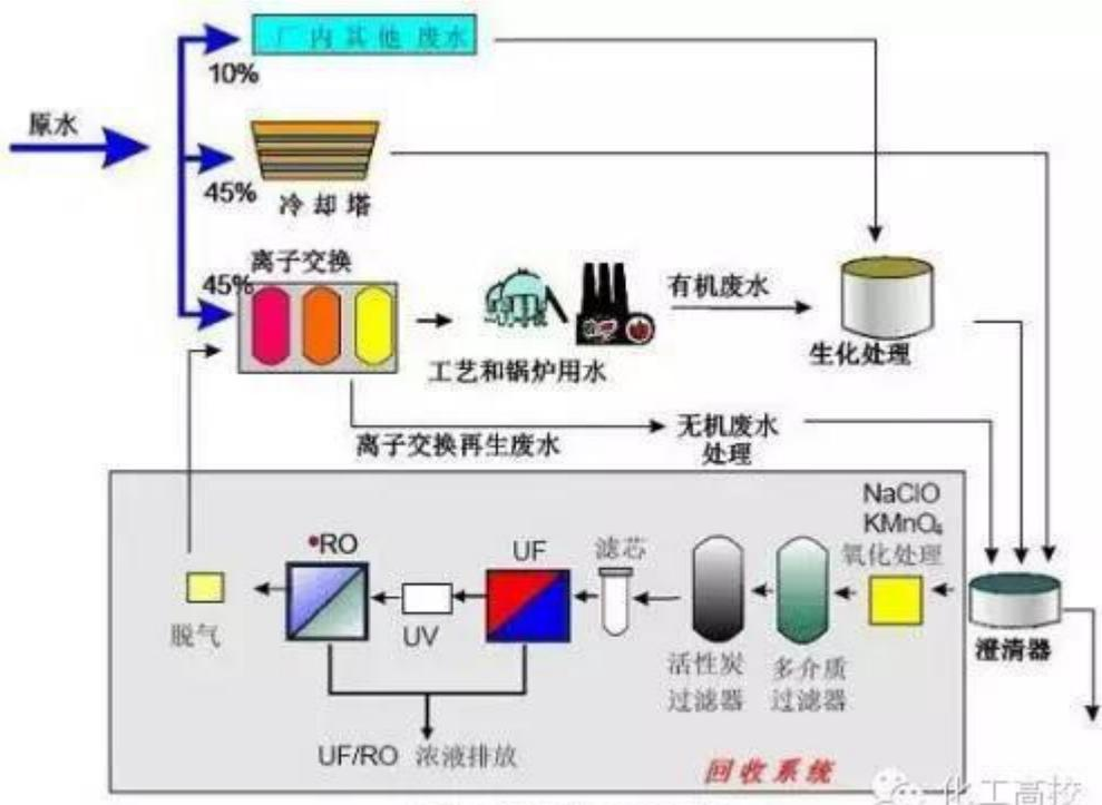
对苯二甲酸废水回用流程图
